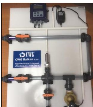
Automatsko odsoljavanje sa doziranjem biocida (AODB) ima za cilj održavanje i praćenje ključnih parametara sistema. Pri čemu su sistemi AO prilagođivi različitim merenjima u zavisnosti od potrebe korisnika. Osnovna primena AO uređaja je održavanje zadatih parametra rashladne vode uz pomoć dreniranja vode iz sistema. Uređaj ima mogućnost merenja temperature, provodljivosti, pH vrednosti, sa vremenski zadatim parametrom doziranja biocida.
