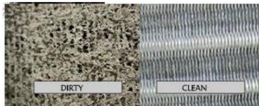
Osim što hemijsko pranje zahteva potpuno stajanje sistema, posledično dovodi i do oštećenja zaštitnih slojeva rashladnih kula, a samim tim skraćuje i životni vek. Kondicioniranjem rashladnih sistema hemikalijama za tretman vode inhibiraće se neželjeni efekti i eliminisatiće se potreba hemijskog pranja. Automatska priprema vode sa doziranjem inhibitora korozije i naslaga (APD) ima za cilj da konstantno održava propisan kvalitet napojne vode rashladnog sistema.
