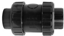
Rückschlagventil S4 DN80 PVC grau PVC-U Klebemuffe d90 metrisch PN10 EPDM EPDM Cone Check Valve S4 DN80 PVC grey PVC-U solvent socket ends d90 metric PN10 EPDM EPDM
