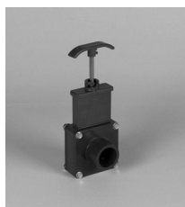
Absperrschieber DN40 PVC grau Innengewinde/Aussengewinde R 1 1/2" BSP PN3,5 EPDM Knife gate valve DN40 PVC grey Female thread/Male thread R 1 1/2" BSP PN3,5 EPDM
